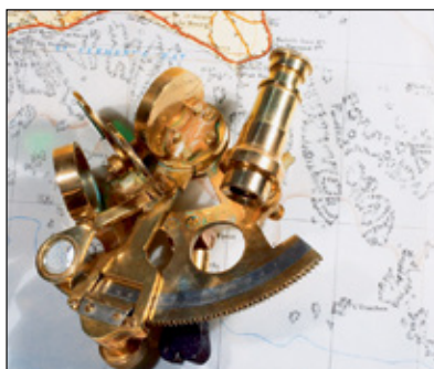
SEXTANTE: instrumento para medir ángulos.
